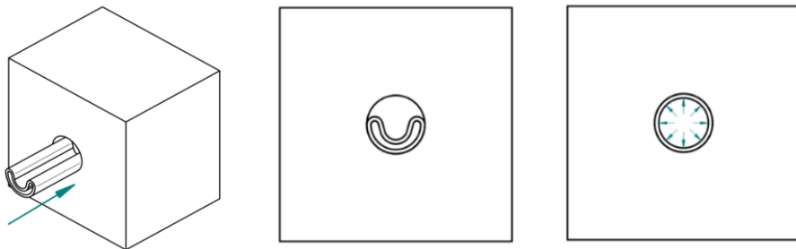
Рис. 6. Установка теплоизоляции в канал трубы.
